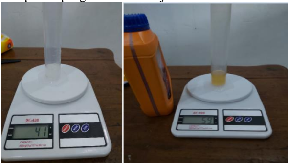
Gambar. 12 Proses penimbangan massa jenis oli
