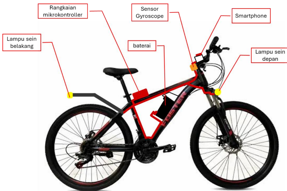
Gbr 9. Sistem dipasang pada sepeda roda dua untuk keperluan pengujian
