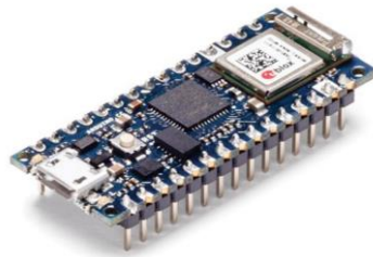
Gbr 3. Tampilan fisik Arduino Nano [7]
